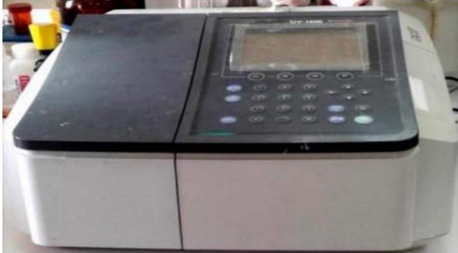
الشكل (III - 12): شكل الجهاز الطيفي (UV-VIS)
