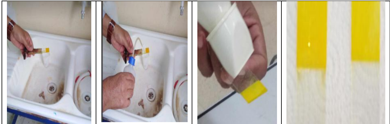
الشكل (III - 7): تشطيف الشرائح بالماء المقطر وتجفيفها
