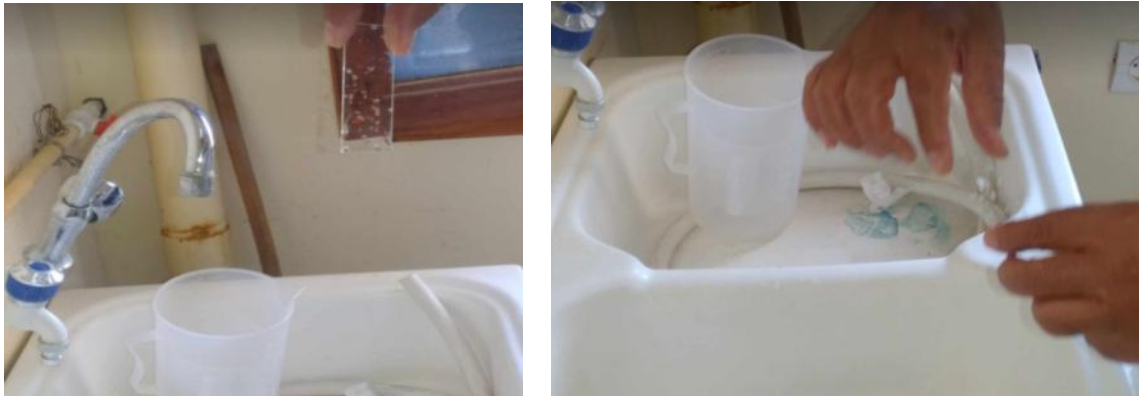
الشكل (III-4) عملية غسل وتحضير الشرائح
