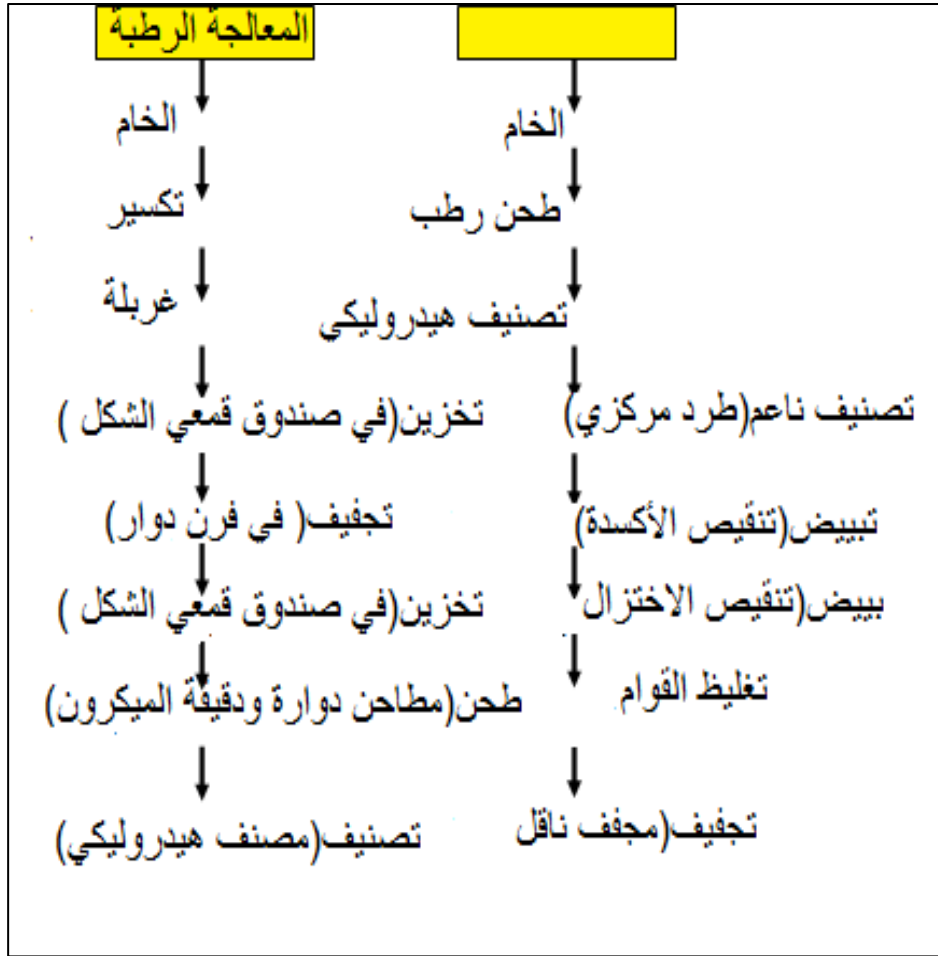
الشكل(4.I): عمليات معالجة خام الزيوليت لإنتاج مئات الورق.
