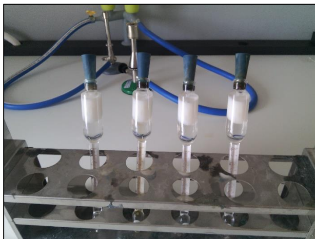
Figure 09 : la juxtaposition verticale de l'acide sulfurique, le colostrum et l'alcool dans les butyromètres avant leurs mélange ( photo originale , 2016)
