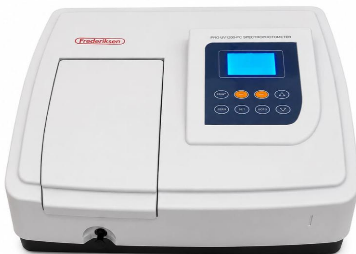
الشكل (9.III): جهاز مطيافية الأشعة فوق البنفسجية (UV-vis).
