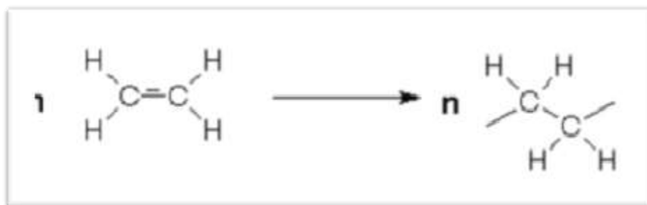
Figure I.8: Polymérisation par ouverture d'une double liaison (d'éthylène, par exemple) [11].
