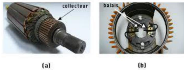
Figure (I.5) : Dispositif collecteur / balais [2].
