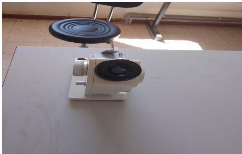
Figure 20 : Un réfractomètre d'ABBE pour la détermination de l'indice de réfraction
