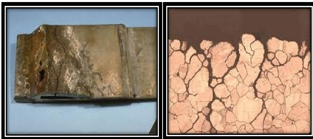
Fig I.7. Corrosion sous contraintes [15].
