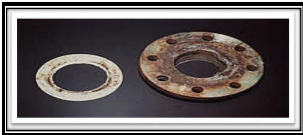
Fig I.5. Corrosion caverneuse d'un acier allié sous un joint [17].
