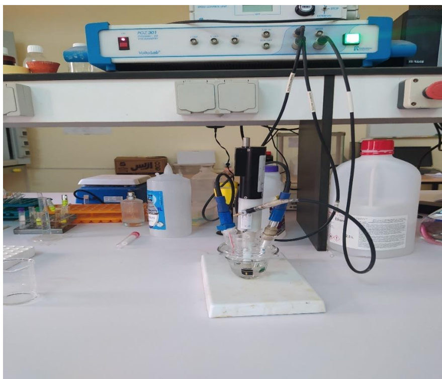
Fig III.1. Un dispositif expérimental utilisé pour mesurer les spectres d'impédance électrochimique.
