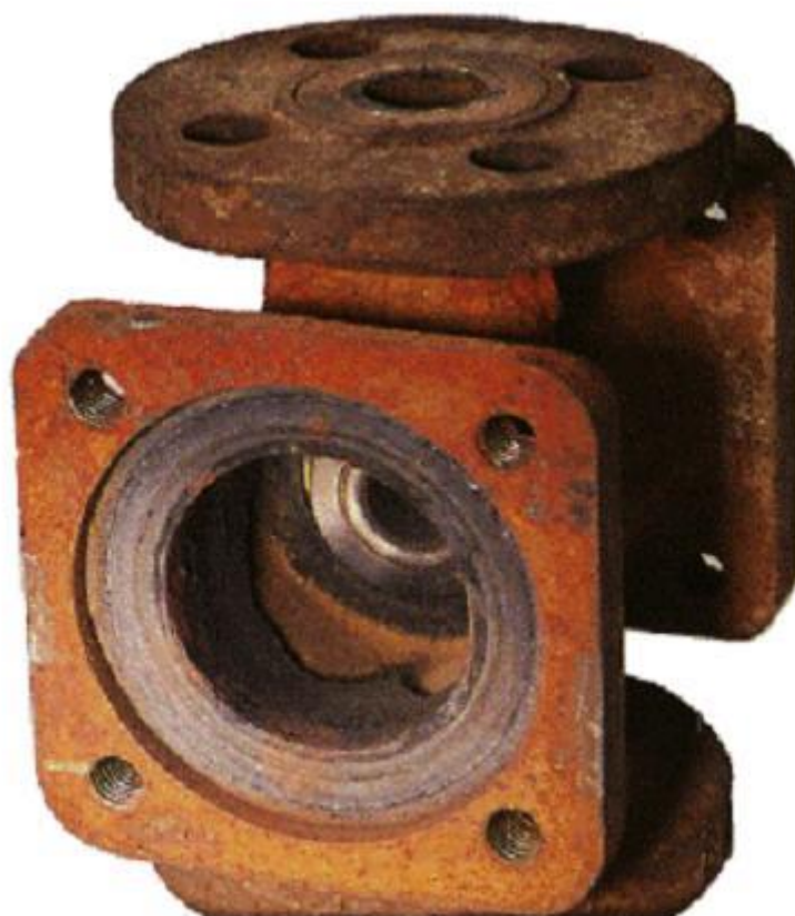
Fig I.1. Corrosion générale (rouille) d'une pièce en acier [11].
