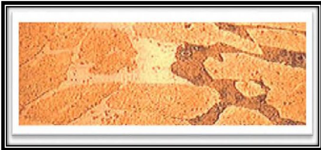
Fig I.6. Coupe métallographique Montrant une corrosion sélective d'un laiton [18].
