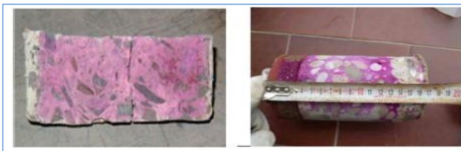
Figure I.7. Phénomène de la carbonatation
