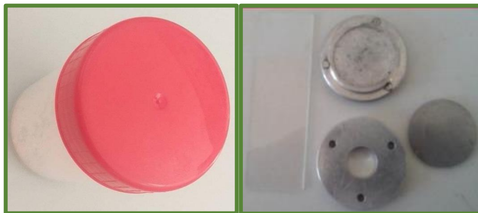
الشكل (III-9): أدوات تحضير العينة للقياس بجهاز الانعراج الآلي.
