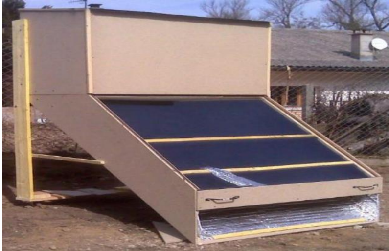
الشكل 2.I: المجفف الشمسي غير المباشر (دراسة الكفاءة الطاقوية للمجفف الشمسي)
