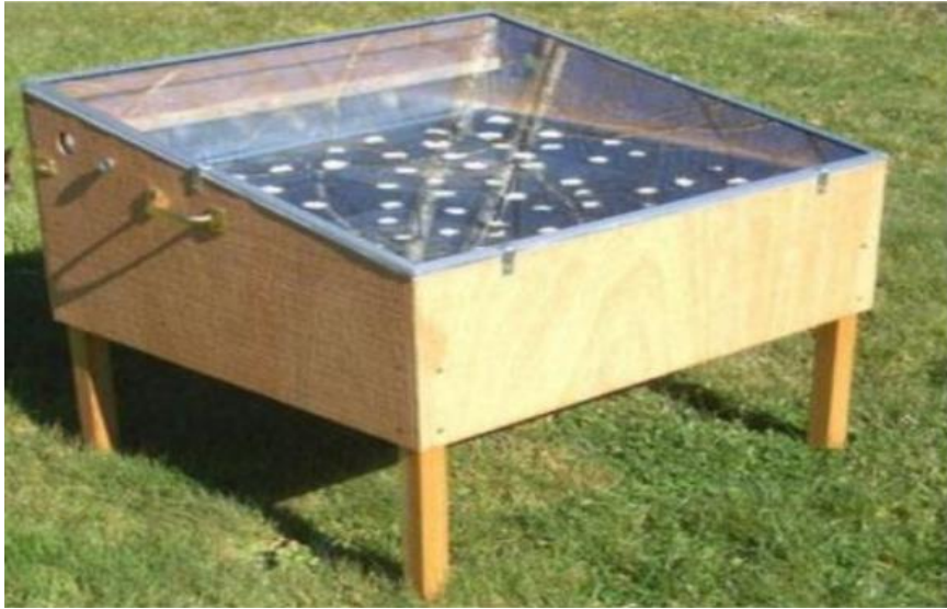
الشكل 1.I: المجفف الشمسي المباشر (دراسة الكفاءة الطاقوية للمجفف الشمسي)
