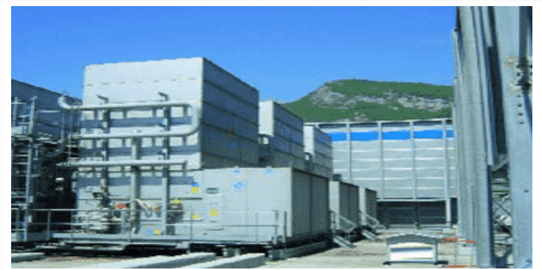
Fig.II.3 : Schéma d'une tour fermée à grands débits d'eau de pulvérisation [75]
