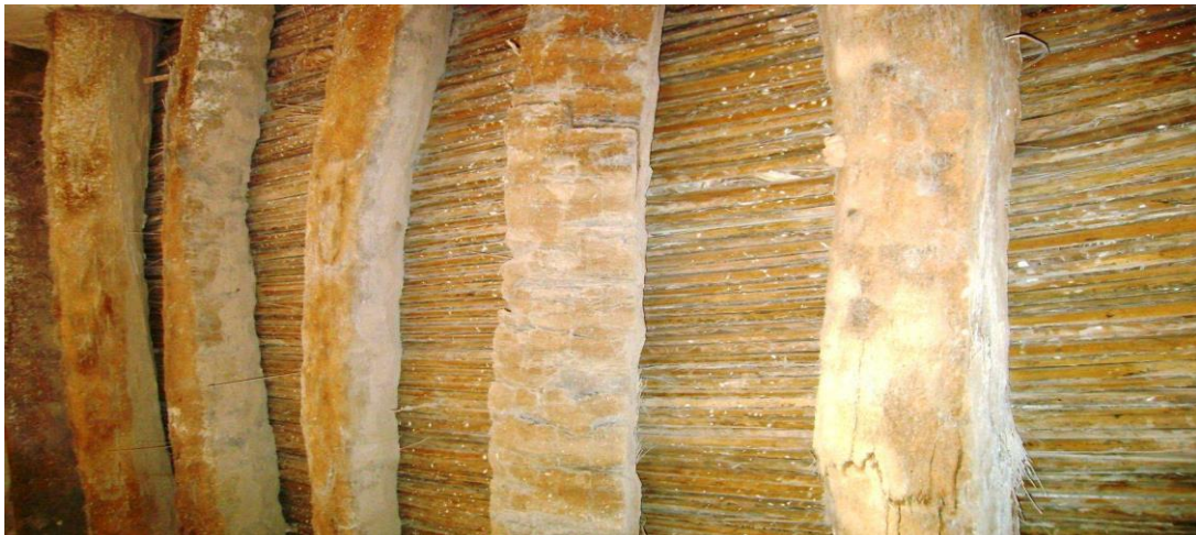
الملحق رقم 22 : الطريقة التقليدية لحرق الجبس داخل الفرن يسمى بالحاروق
