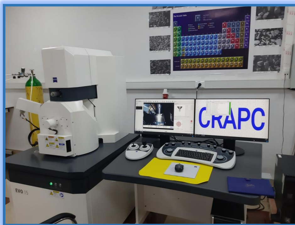
الشكل (12-2): مجهر Zeiss Evo 15 المستعمل للحصول على صور البنية المجهرية للعينات.
