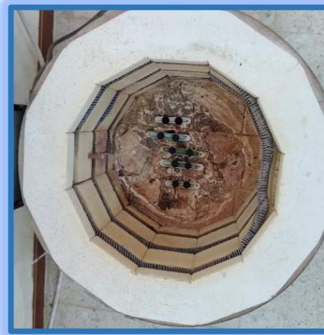
الشكل (3-14): الأقراص في الفرن لعملية التليد.
