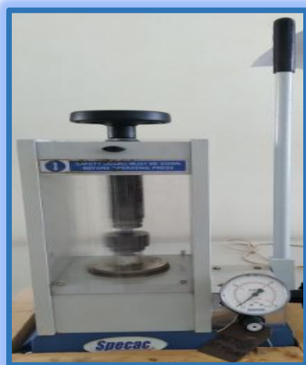
الشكل (11-3): الكلسنة 1 للمساحيق في الفرن. الشكل (12-3): آلة الضغط الهيدروستاتيكي من نوع SPECAC.
