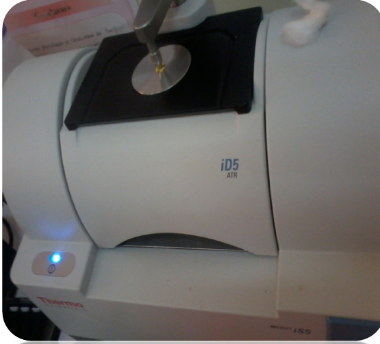
الشكل (13.II): كيفية ضغط ذراع على العينات الصلبة في جهاز IR-ATR
