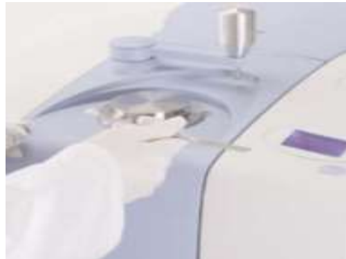
الشكل (9.II): طريقة وضع العينات الصلبة في جهاز ATR
