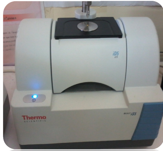
الشكل (12.II): طريقة وضع حبوب اللقاح في جهاز IR-ATR
