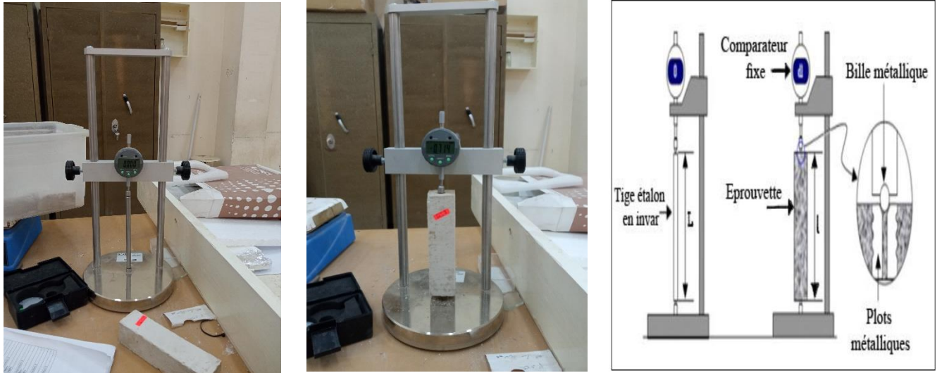
Figure II-20: Dispositif de mesure de retrait
