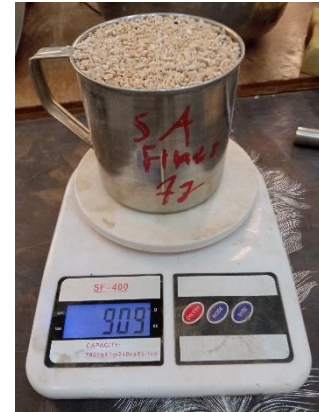
Figure II-5: essai de la masse volumique apparente Source l'auteur
