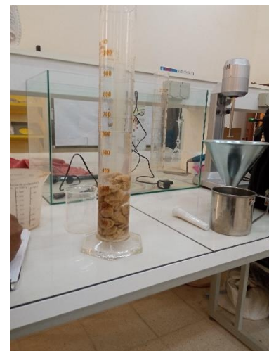
Figure II-6 : essai de la masse volumique absolue Source l'auteur
