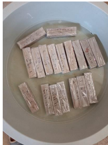
Figure II-22: Essai d'absorption d'eau par capillarité
