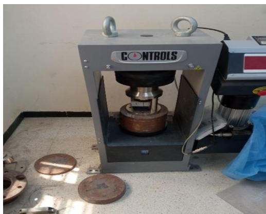
Figure II-17: écrasement des éprouvettes dans l'essai d'compression
