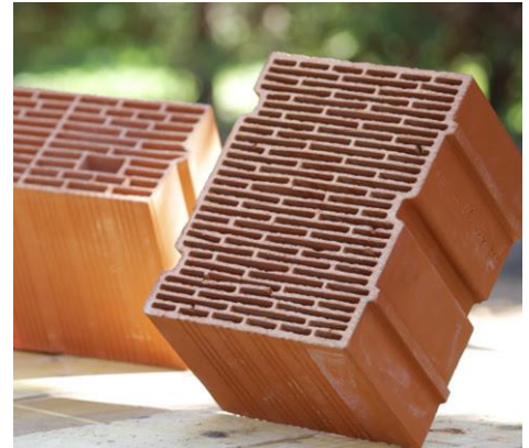
Figure I-18: Briques creuses de terre cuite à perforation verticale type G
