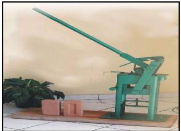
Figure I-13 : Brique de terre crue comprimée réalisée à l'aide d'une presse manuelle
