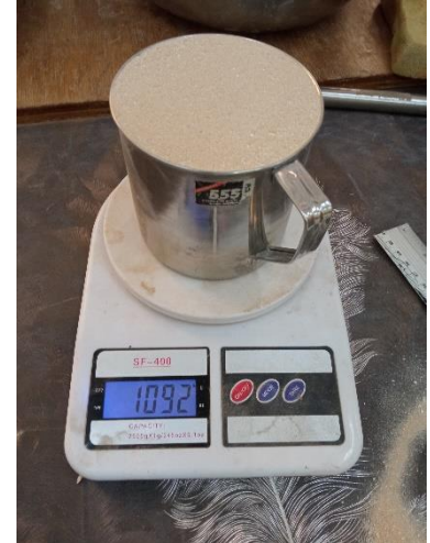
Figure II-8 : essai de masse volumique de plâtre Source l'auteur
