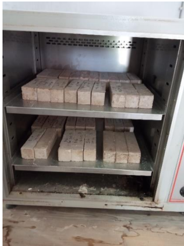
Figure II-22: Essai d'absorption d'eau par capillarité
