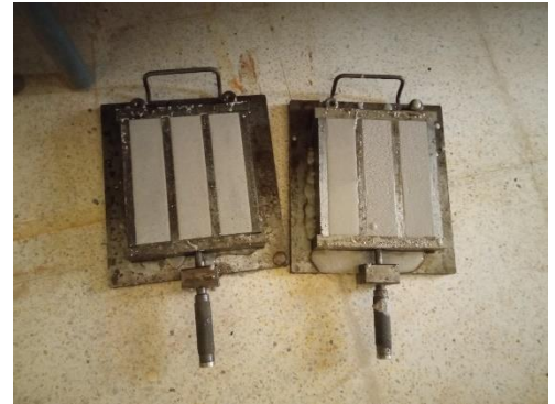
Figure II-13: les éprouvettes après le coulage de plâtre dans le moule 4*4*16
