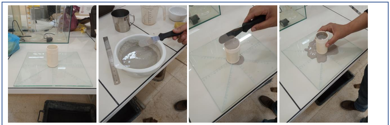
Figure II-10: essai de consistance du plâtre
