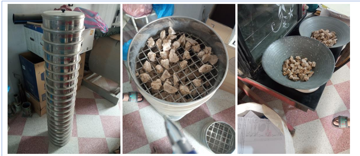
Figure II-3: Les opérations principales de l'essai granulométrique
