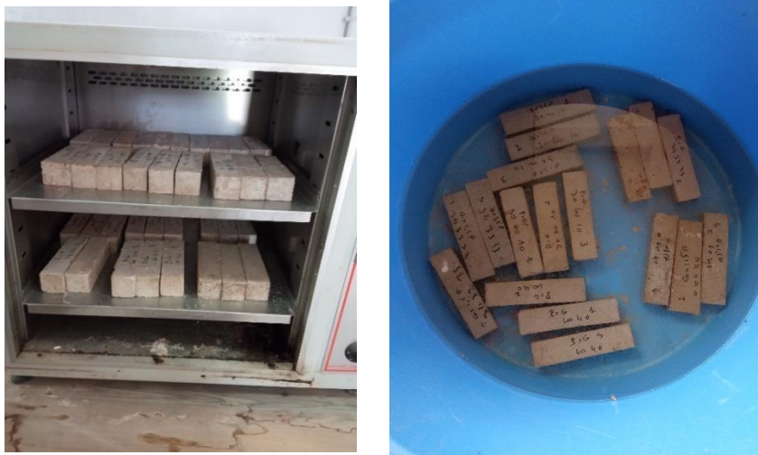
Figure II-21: essai d'absorption d'eau par immersion totale
