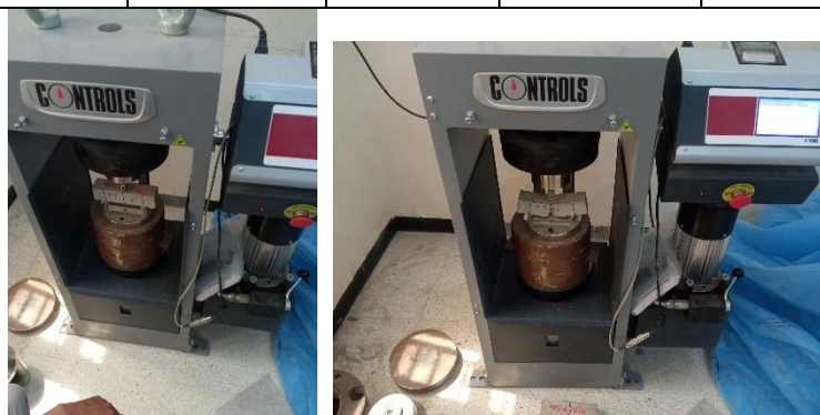
Figure II-15: écrasement des éprouvettes dans l'essai traction par flexion
