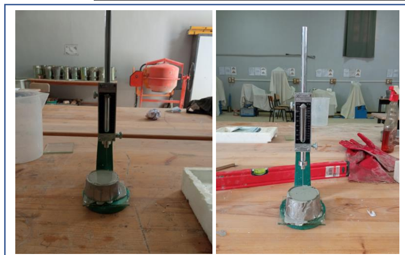
Figure II-12 : Essai de prises par l'appareil Vicat
