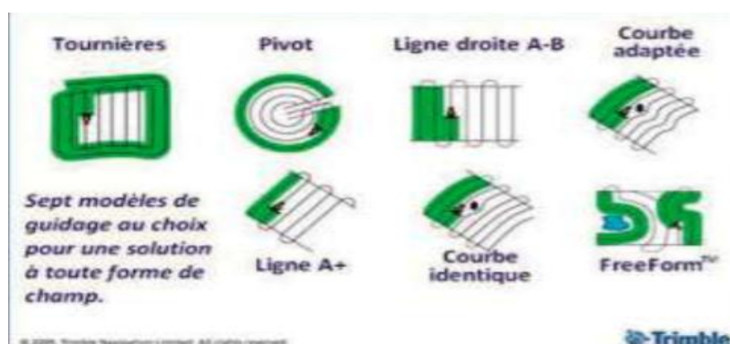
Figure III.12 : Les différents types de lignes de références programmables sur une console de guidage [34].
