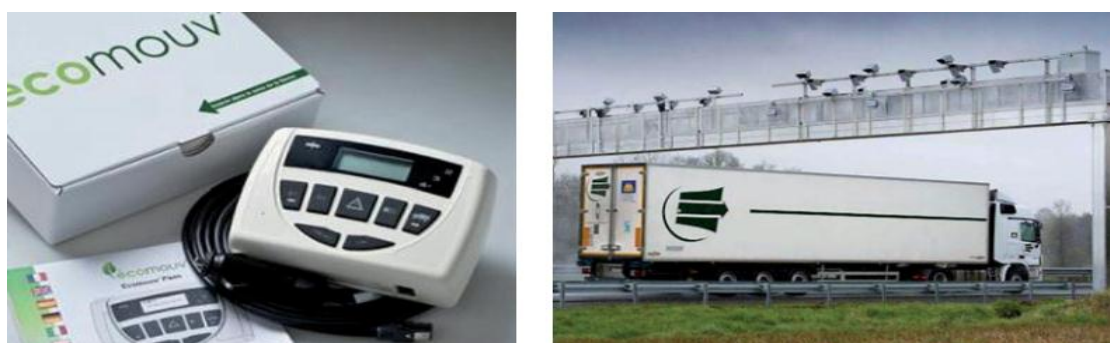
Figure II.27 : Équipement embarqué et portique de contrôle du système Ecotaxe [17].
