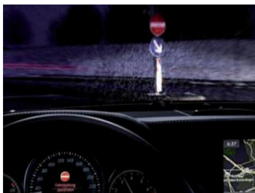
Figure II.20 : Signal d'alarme de conduite en contre-sens se déclenche en cas d'action incohérente du conducteur (Crédit Daimler) [25].
