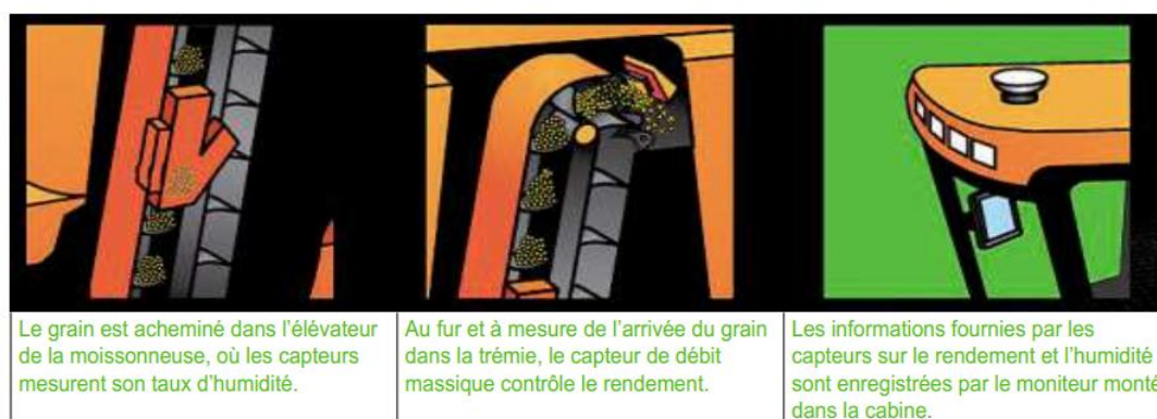
Figure III.14 : Schéma de montage d'un capteur de rendement et d'humidité sur une moissonneuse-batteuse [34].
