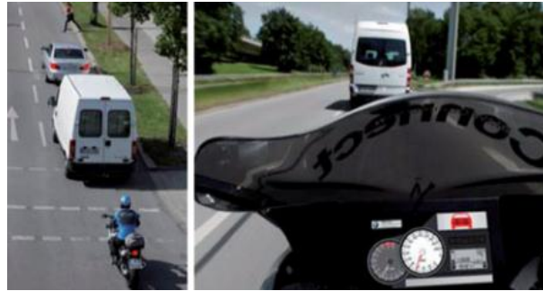
Figure II.23 : La moto reçoit une alerte de freinage brusque en provenance de ma voiture placée devant la camionnette [21].
