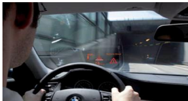
Figure II.24 : Le conducteur reçoit une alerte concernant un obstacle caché par l'ombre du tunnel [21].
