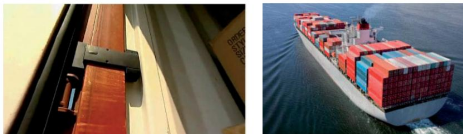
Figure II.6 : Boîtier de géolocalisation pour conteneur ConLock (Crédit Global Tracking Technology) [20].
