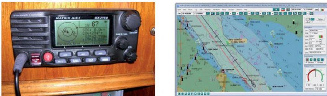
Figure II.3 : Récepteur AIS de plaisance (Standard Horizon) et logiciel professionnel (Euro Nav) [17].
