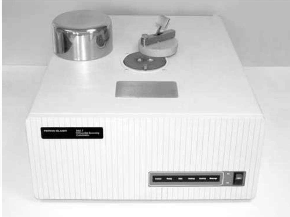
Figure A.1 : Calorimètre différentiel à balayage ésilu (DSC 7 - Perkin Elmer)
