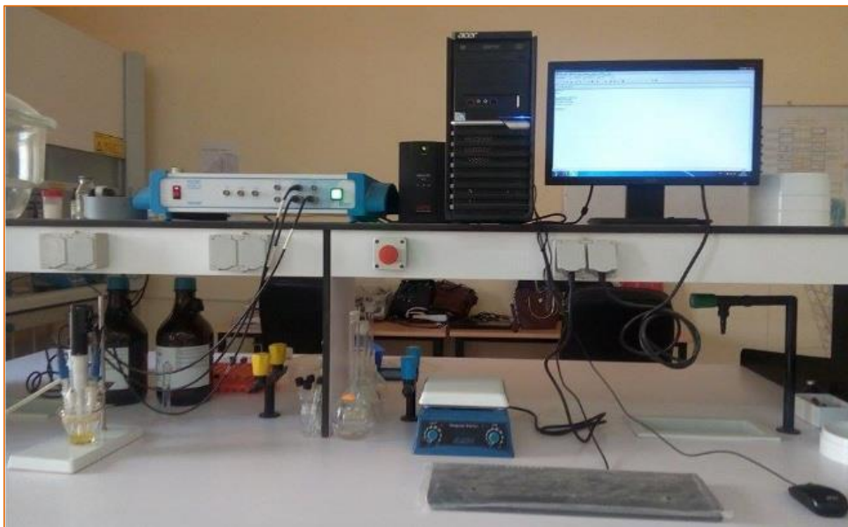
Figure 21 : Dispositif expérimental voltampérométrique.
