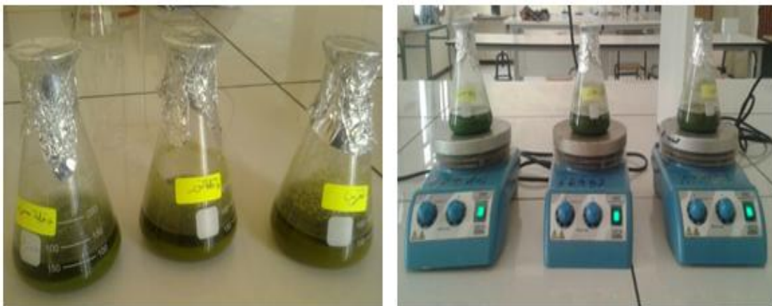
Figure III.4. Extraction par macération
