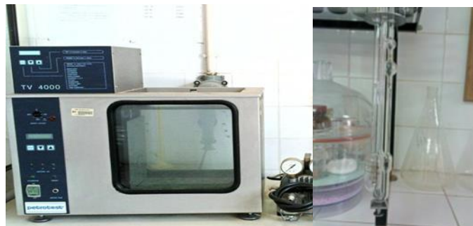
Figure III-3: L'appareillage de mesure de la viscosité cinématique.
