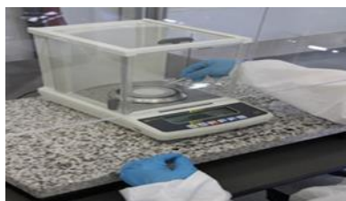
Figure III-6: Mesure la salinité par analyse gravimétrique.
