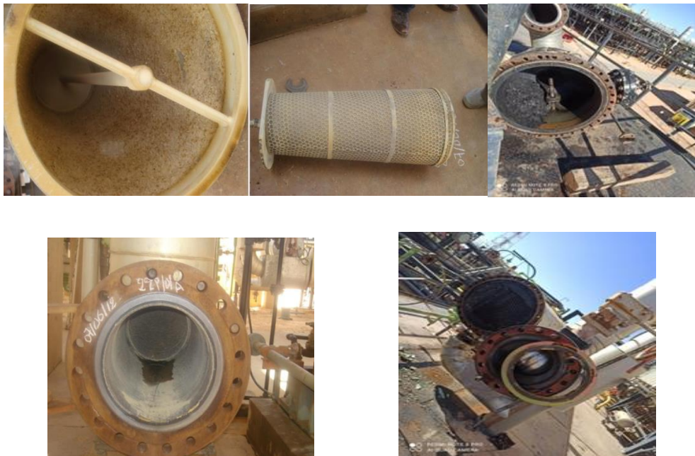
Figure II-1: Précipitation des sels au niveau des parties chaudes du process Modul II.
