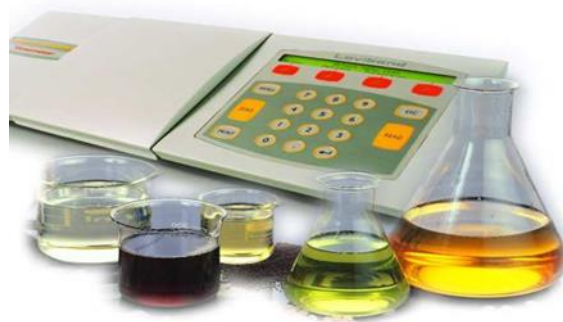
Figure III-10: Appareil de Tintométrie LOVIBOND PFX880
