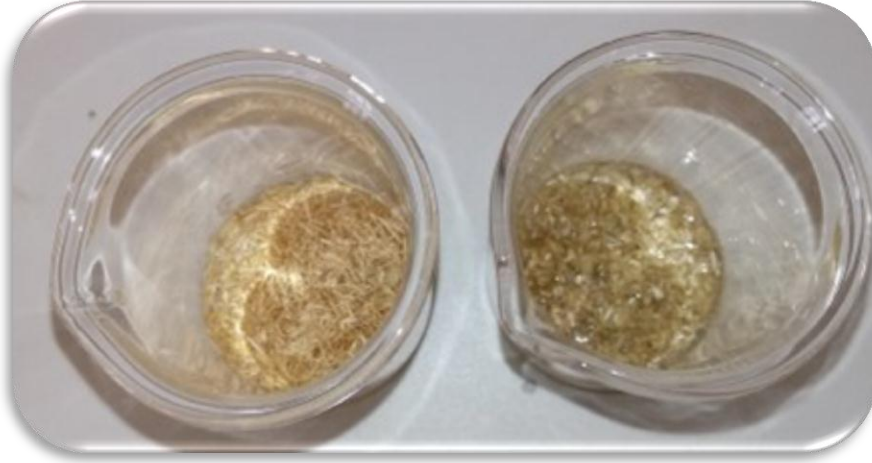
الشكل III-25: صور توضح قابلية التبلل لكلا من المسحوقين
