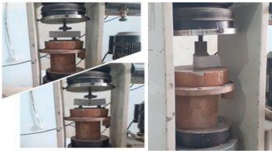
صورة توضيحية لتجربة التحطيم بواسطة الانحناء والضغط البسيطين للعينة خلال 7 أيام
