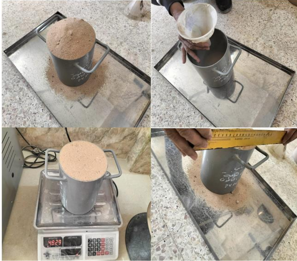
الصورة (07): خطوات تجربة الكتلة الحجمية الظاهرية
