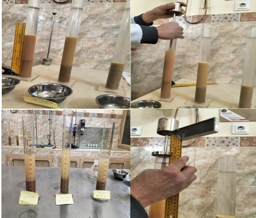
الصورة (10) : خطوات عمل تجربة المكافئ الرملي. [1]
