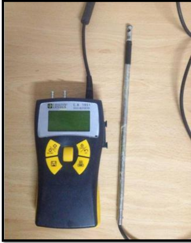
الشكل(3-10): صورة توضح جهاز الأنيمومتر لقياس سرعة الهواء
