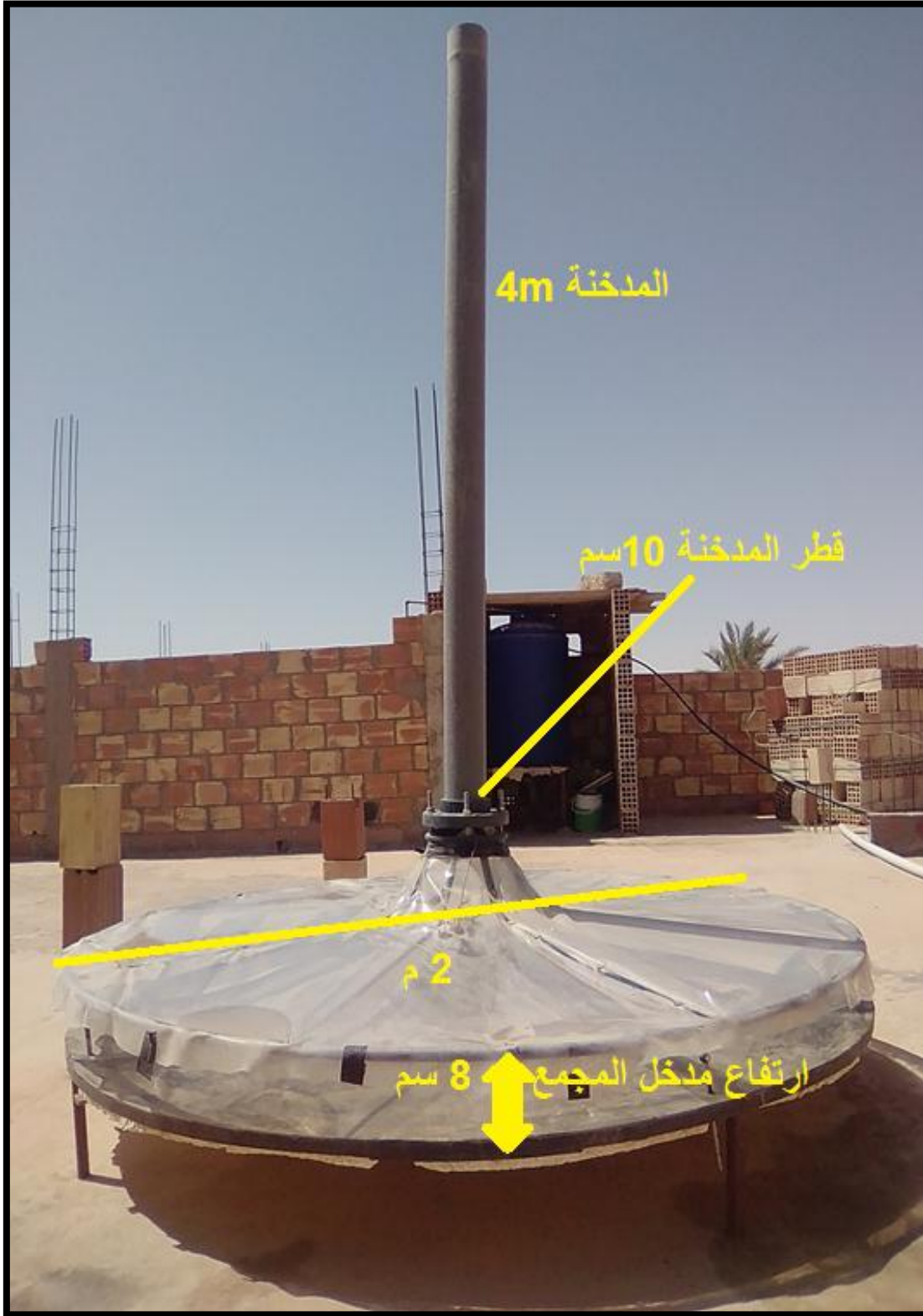
الشكل(3-44): الأبعاد والتصميم الأمثل لأداء افضل للمدخنة الشمسية بالجنوب الشرقي للجزائر (وادي سوف)
