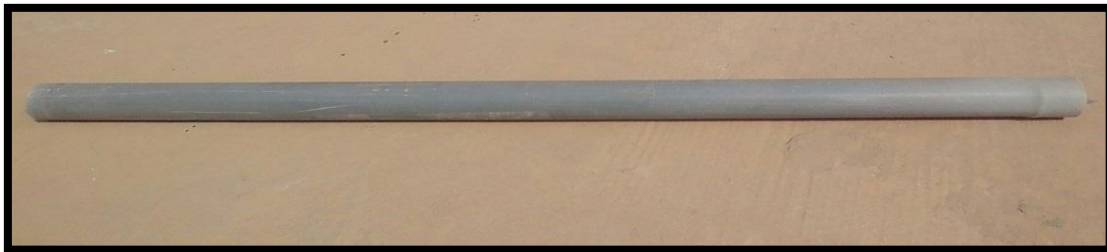
الشكل(3-22): مدخنة (انبوب) في المدخنة الشمسية طولها (4m)
