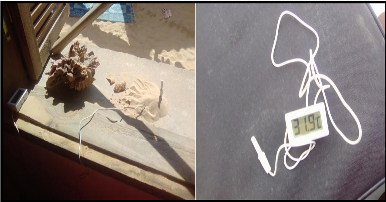
الشكل(3-9): صورة توضح جهاز التارموكوبل لقياس درجة حرارة الجو
