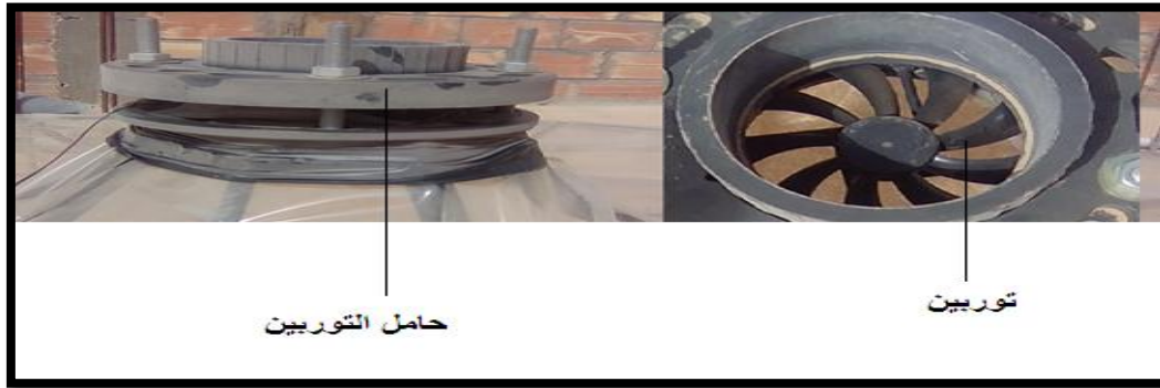
الشكل(23-3): صورة توضح التوربين وحامله
