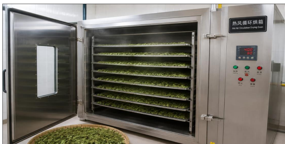
الصورة 05: توضح فرن مستخدم في التجفيف الصناعي للأعشاب الطبية (Pixabay, 2026).
