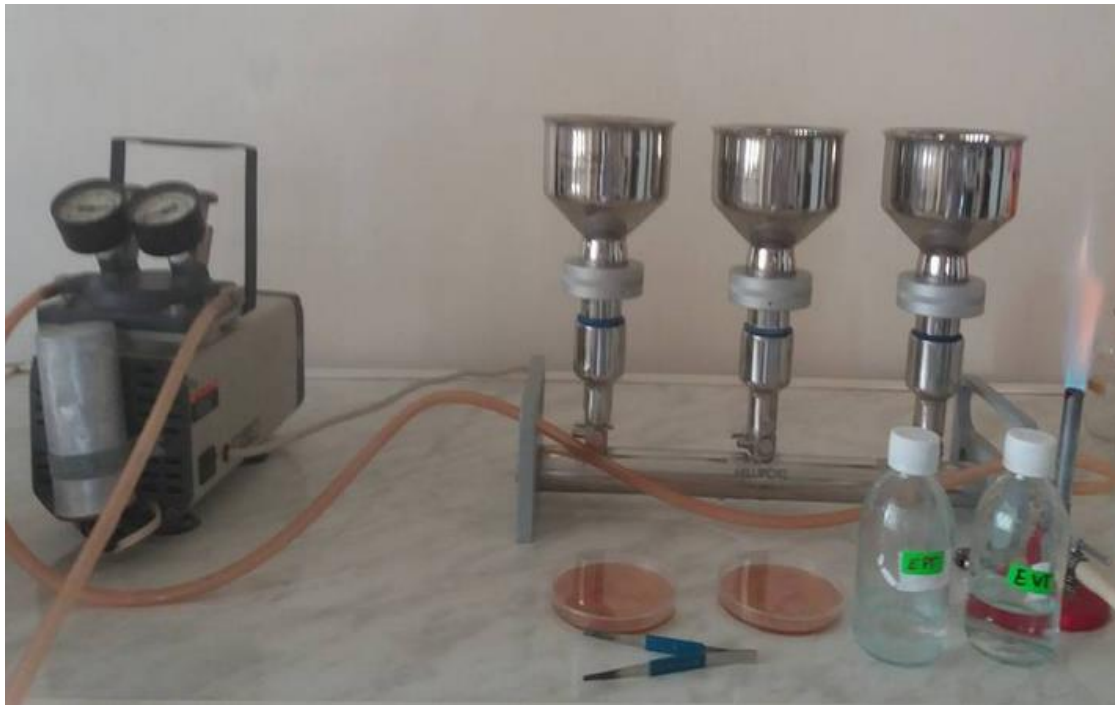
Figure 10: Dispositif de filtration sur membrane.
