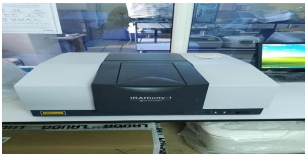
الشكل (10-II): جهاز FTIR المستعمل في الدراسة.
