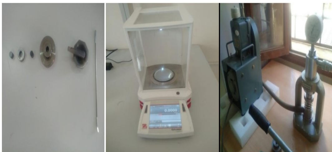
جهاز الضغط والمؤقت الميزان جهاز الطحن وقالب العينة
