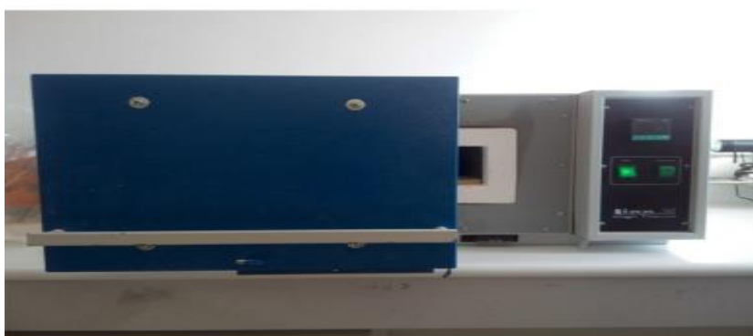
الشكل (III-3): الفرن الكهربائي المستخدم في التسخين.
