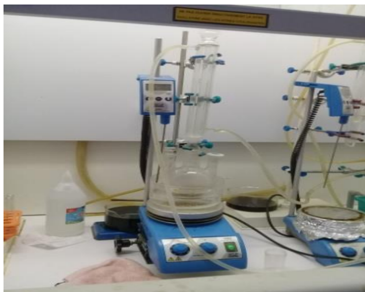
الشكل (III-2): صورة لتجهيز montage reflux
