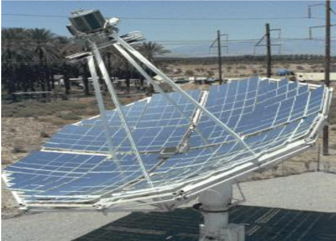
Figure I. 10 : Le système solaire Vanguard par Advanco Corporation avec une puissance de 25 kWe.
