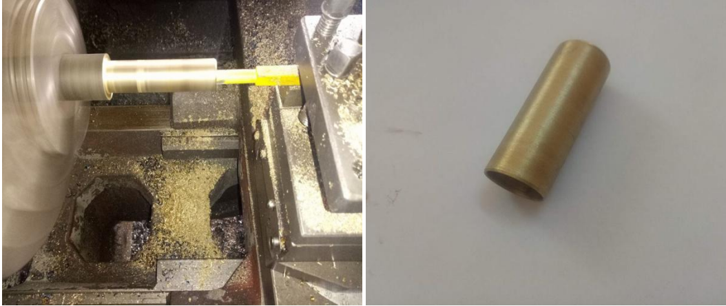
Figure III. 19: Photo du cylindre du piston.
