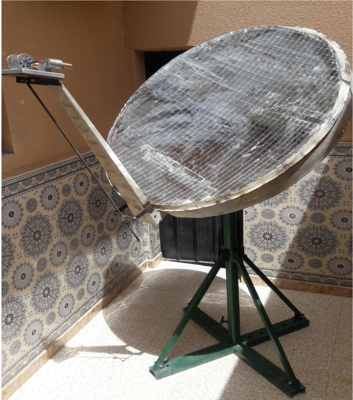
Figure III. 25: Image du moteur Stirling connecté au concentrateur à miroir parabolique.
