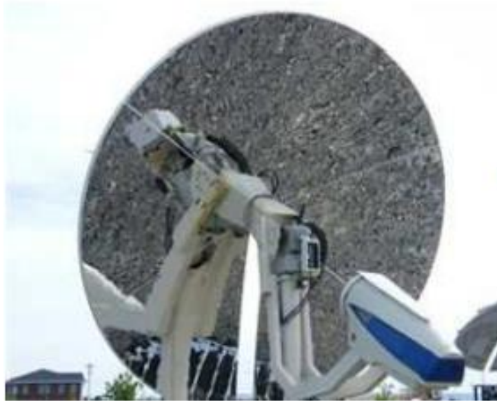
Figure I. 15 : Système Parabole/Stirling de 3,2 kWe de la centrale d'InfiniaCorp.
