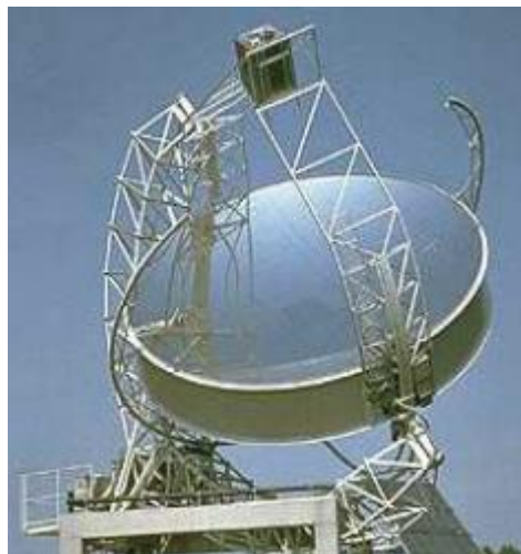
Figure I. 12 : Le système solaire DISTAL I avec une puissance de 9 kWe par SBP installé à Pforzeim en Allemagne.
