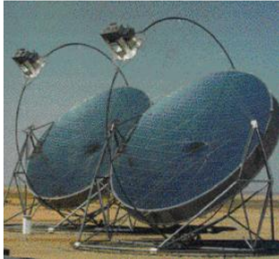
Figure I. 11 : Les deux systèmes solaires de type Parabole/Stirling avec une puissance de 50 kWe installés en 1984 à Riyadh.
