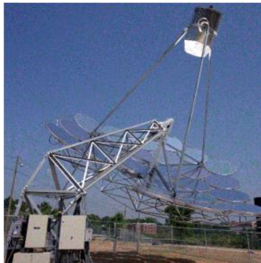
Figure I. 13 : Le système solaire de type Parabole/Stirling par CPG avec une puissance de 7,5 kW e.
