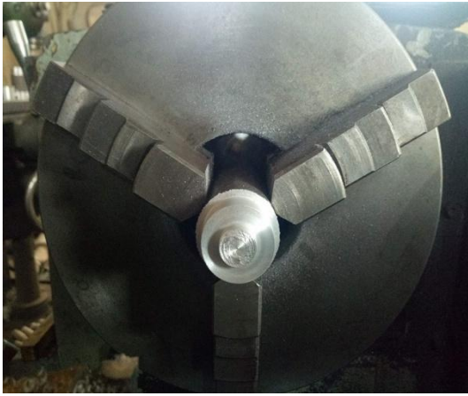
Figure III. 16: Photo du piston moteur au tour.
