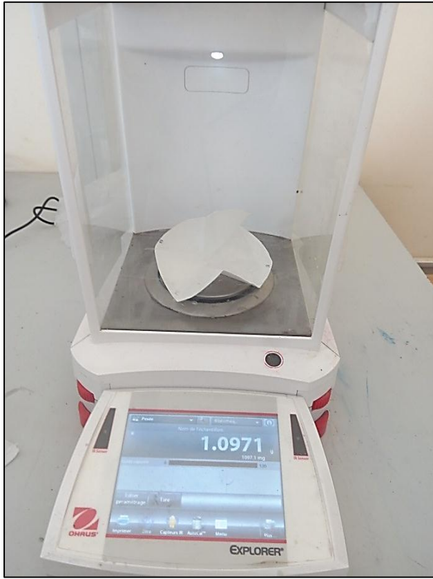
الصورة 6.IV : وزن كمية المواد غير الذائبة على ورق الترشيح.
