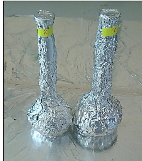
الصورة 9.IV : العينات في الظلام بالإضافة لعملية الترشيح.
