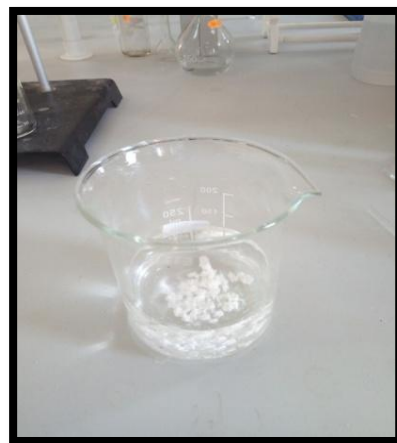
(الشكل III-5) عملية التجفيف بـ \text{CaCl}_2
