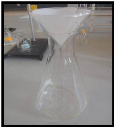
(الشكل III-6) عملية الترشيح العادي
