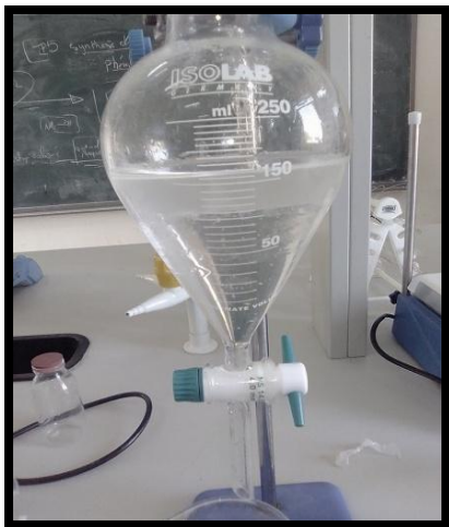
(الشكل III-4) الاستخلاص سائل-سائل
