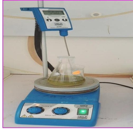
الشكل (III-8): يمثل العملية المعالجة الكيميائية بالرج المغناطيسي.
