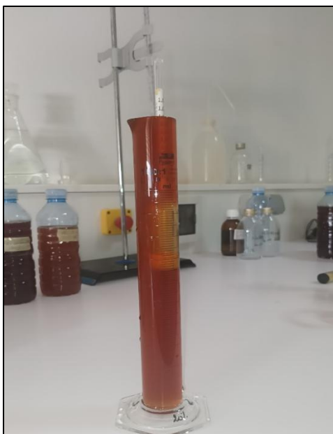
Figure 17 : Mesure de la densité en densimètre en laboratoire (Originale, 2026).
