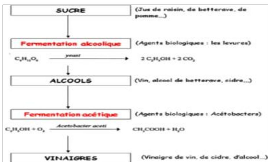
Figure 4 : Diagramme de Fabrication de vinaigre (Addad rawida& Ouahiani soumia).
