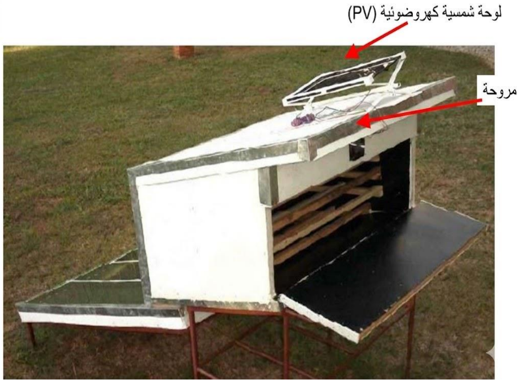
الشكل II.5. مروحة مدعومة باللوحة الكهروضوئية [21].
