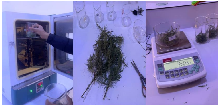
الصورة III.14. التجفيف بواسطة الفرن الكهربائي
