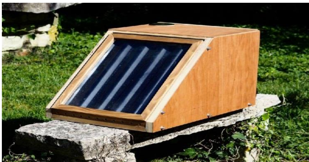
الشكل I. ١٠. مجففات الطاقة الشمسية المباشرة (مجففات الدفيئة)
