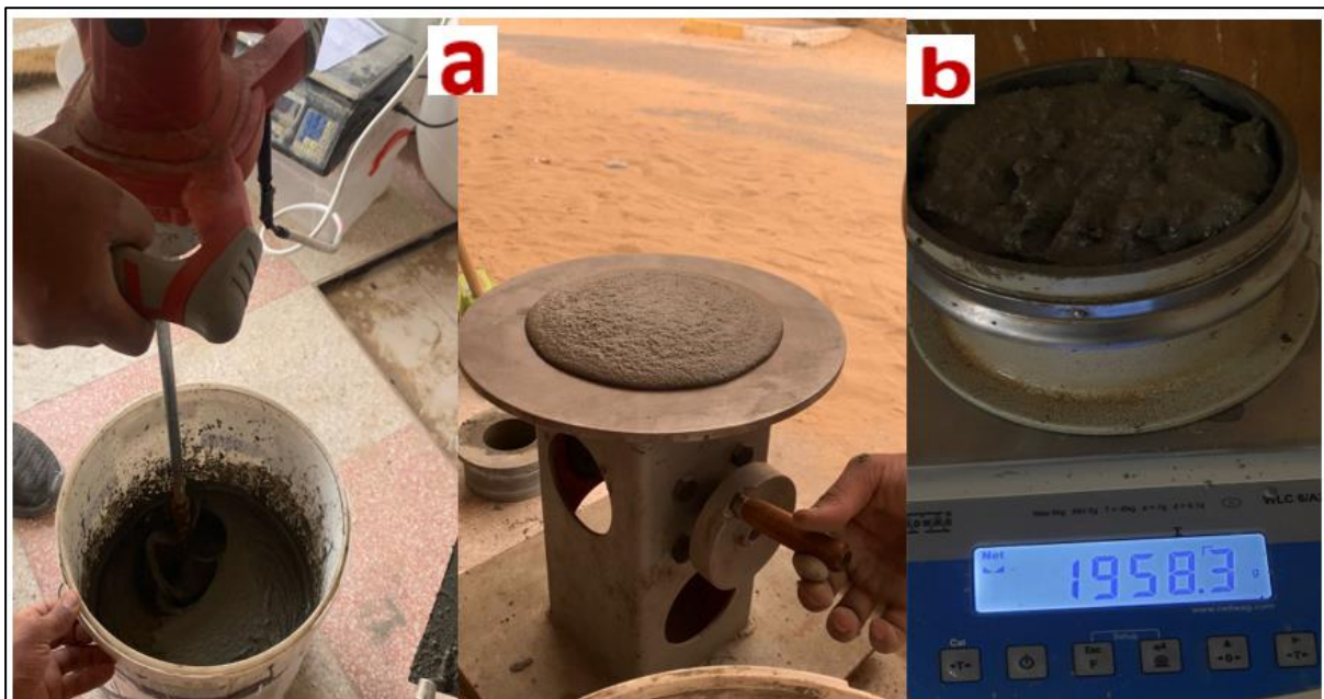
Figure II-6 : Les essais à l'état frais, (a) l'étalement, (b) la masse volumique .
