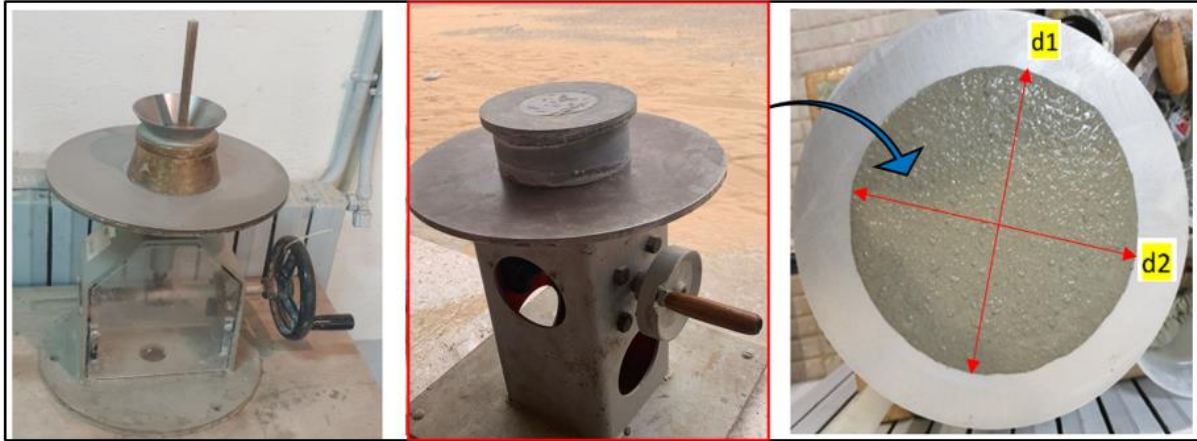
Figure II-9 : Equipements tables à secousses et méthode de la mesure de l'étalement.
