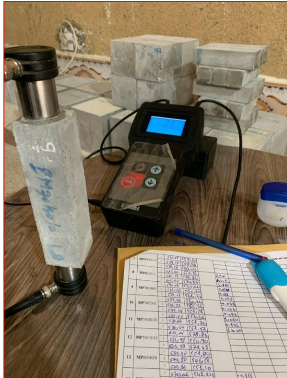
Figure II-10 : Mesure de la vitesse d'impulsion ultrasonique du mortier étudié.
