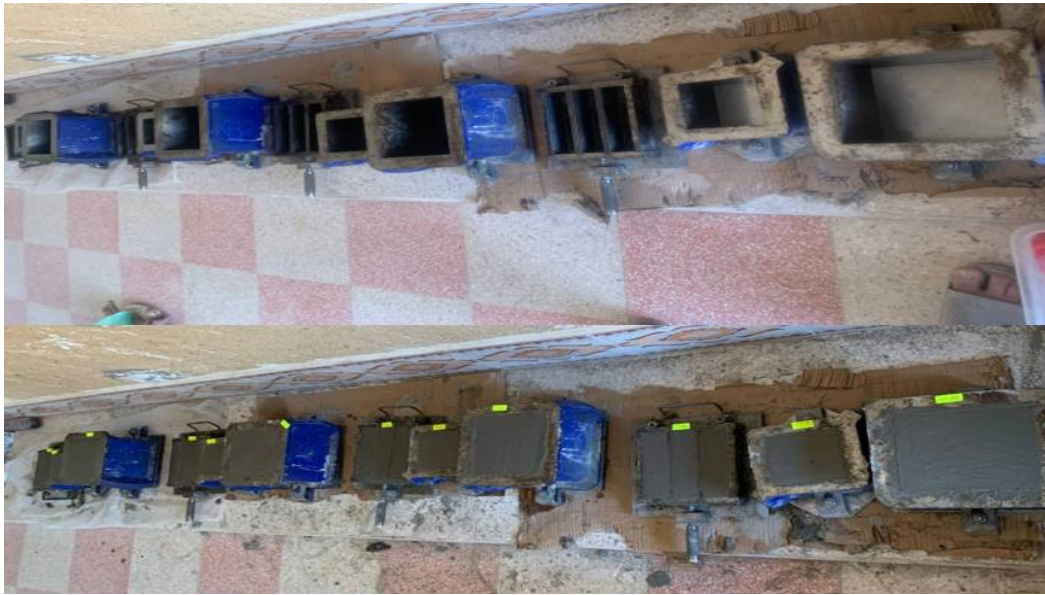
Figure II-7 : Huilage des moules et nivellement de la surface du mortier.
