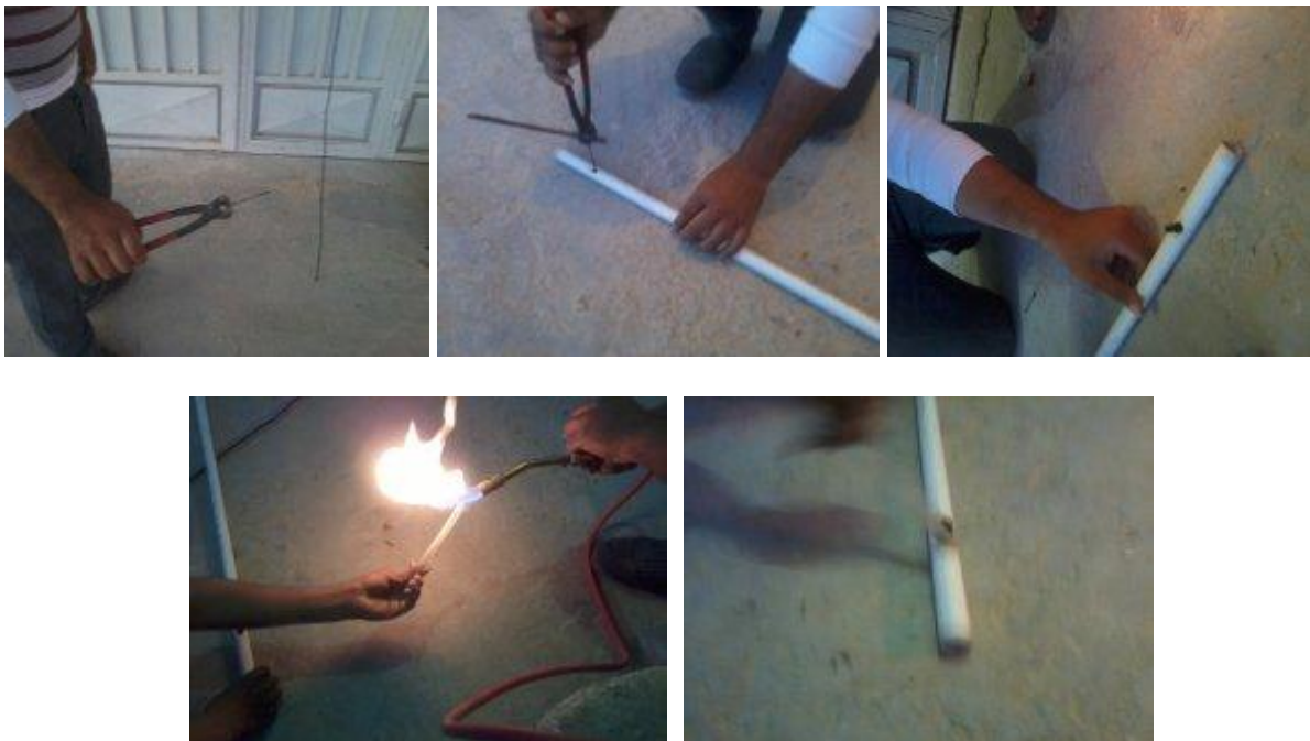
Figure2.2 : Faire un trou dans un tube de PVC
