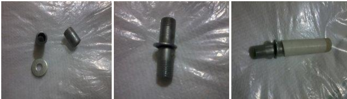
Figure2.4 : Faire diaphragme dans un tube de PVC
