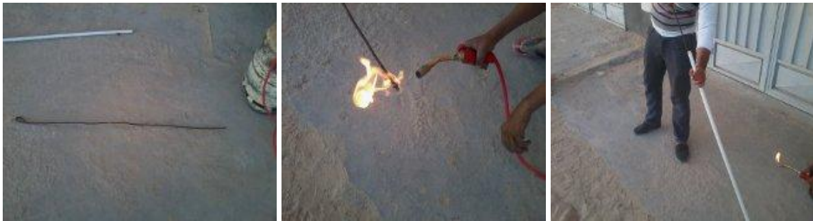
Figure2.3 : Faire de la rugosité dans un tube de PVC
