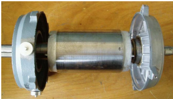
Figure I.16: Une barre partiellement cassée et un barre complètement cassée [GAE04]
