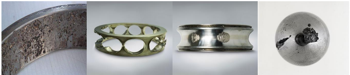
Figure I.20: Certains des défauts de roulement a billes [SW15],[SW16],[SW17],[SW18]
