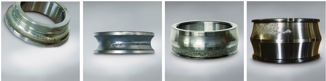
Figure II.11: Dommage écaillage par type de roulement
