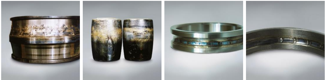
Figure II.12: Dommage Grippage par type de roulement
