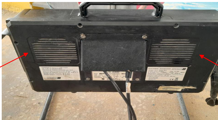
Figure IV.4: les deux ventilateurs.
