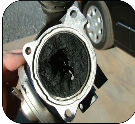
Figure II.8: la vanne EGR avec sédiments[34]
