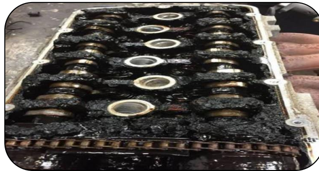
Figure II.6: Moteur diesel encrassé par l'huile.
