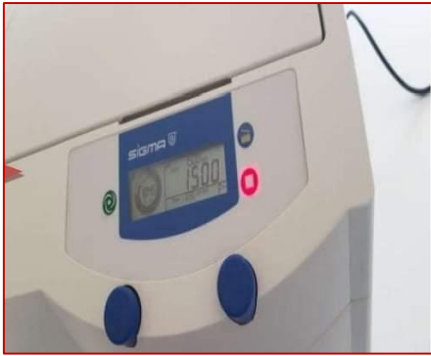
9) Centrifugation (1500 t/min pendant 15 min)
