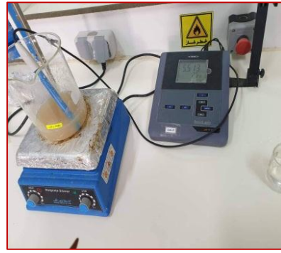
8) Ajustement du pH =5.5 par NaOH 1 N
