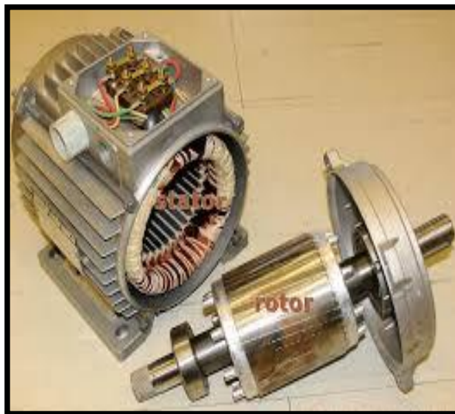
Figure I. 1: stator et rotor de la machine synchrone à aimants permanents.
