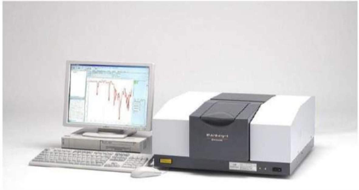
Figure IV.1 : Schéma spectromètre à transformée de Fourier.
