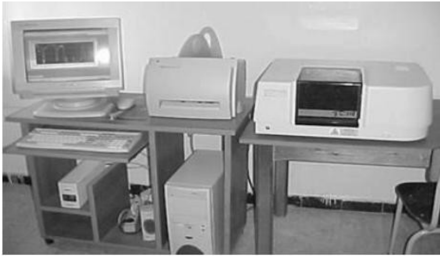
الشكل (II-8): جهاز مطيافية الأشعة تحت الحمراء ولواحقه.
