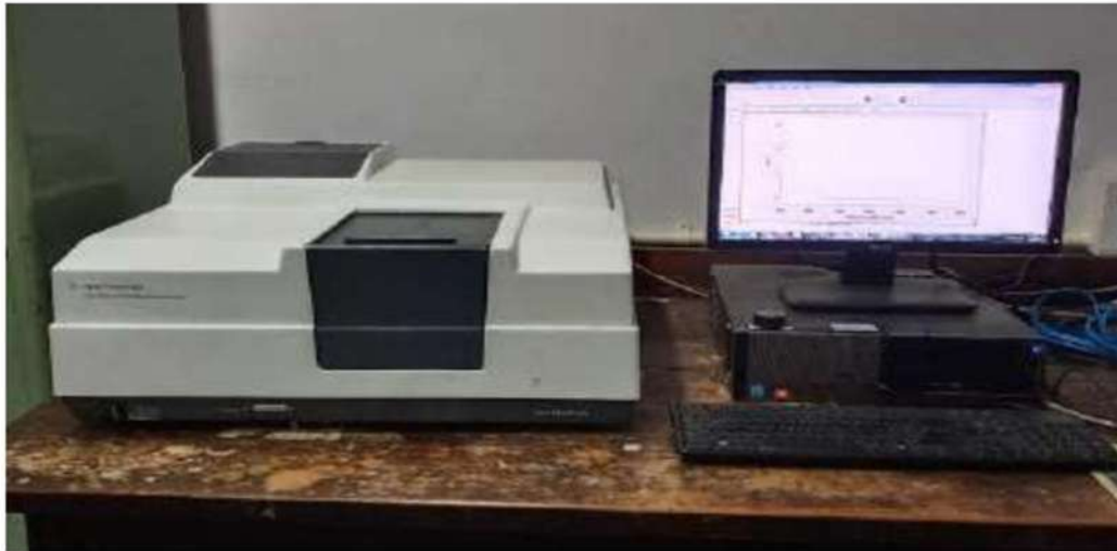
الشكل (II-17): جهاز مطيافية الأشعة فوق البنفسجية والمرئية [23].
