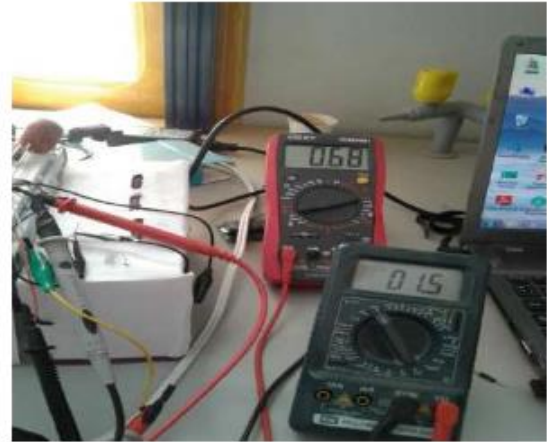
Figure (I 9) : Test de mesure du courant I_{cc}
