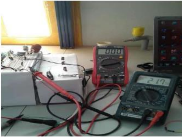
Figure (I 8) : Test de mesure de la tension V_{co}
