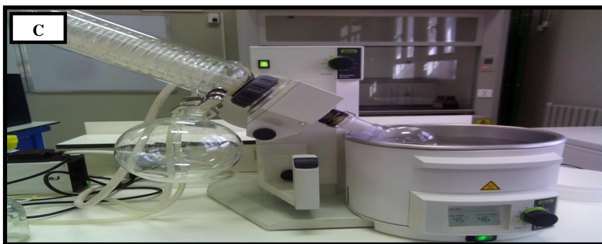
Figure 06 : Extraction des mycotoxine de Fusarium : A) - ampoules a décompté; B) - la phase organique et la phase inorganique; C) - l' évaporation du solvant par rotavapor .
