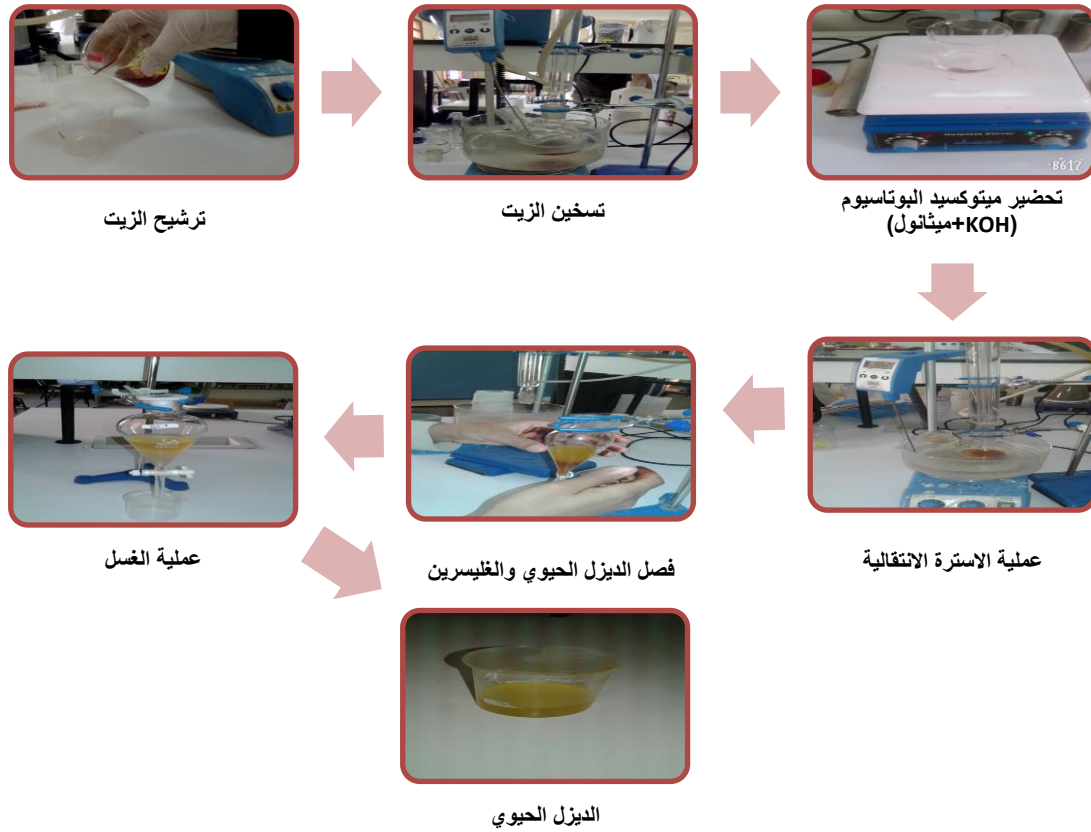
الشكل 4: مخطط يوضح مراحل تفاعل الاسترة الانتقالية
