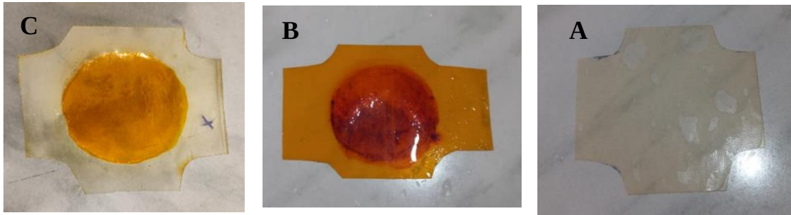
الشكل (8.IV): صورة الغشاء أنيوني AMX (A): الغير المستعمل. (B): مستخدم في ED التقليدي و (C): مستخدم في ED-EF.
