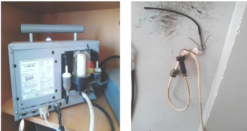
Figure IV.1 : Analyseur et capteur de gaz dans le moteur à essence.
