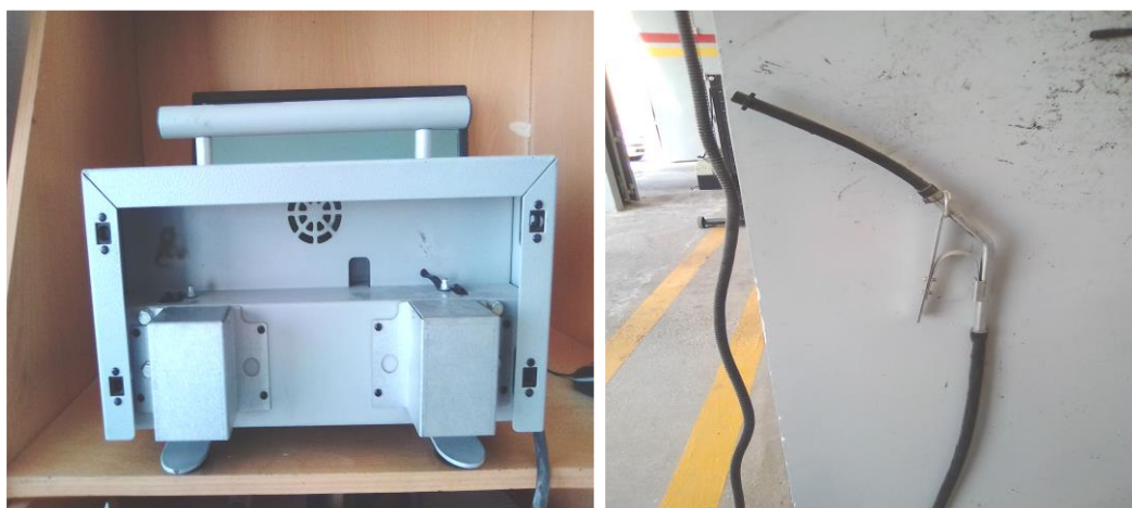
Figure IV.2 : Opacimètre et capteur de gaz le moteur Diesel.
