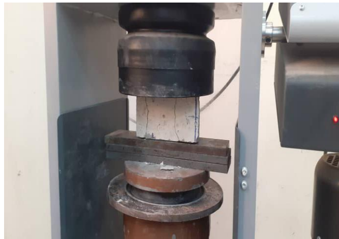
Figure II.14. Dispositif de l'essai de la résistance à la compression.
