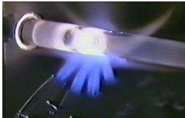
Figure I-7 : Fabrication de la préforme.
