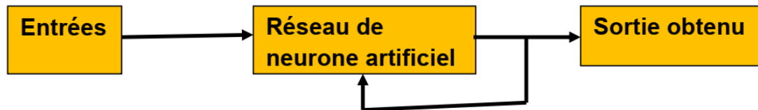
Figure II.10. Schéma bloc de l'apprentissage non supervisé d'un réseau de neurone. [24]
