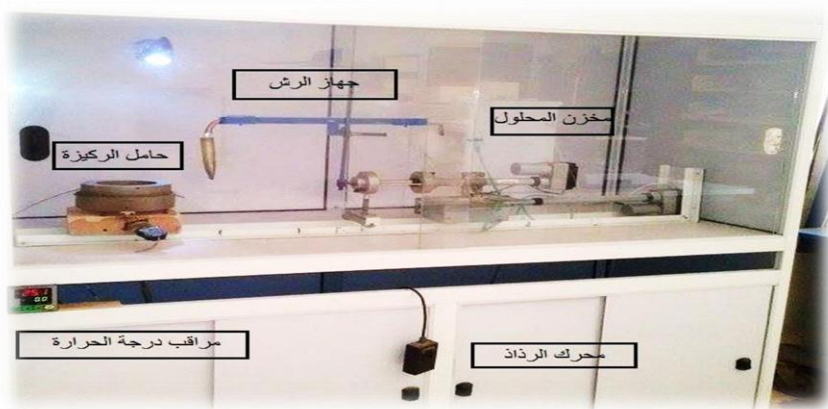
الشكل (4-III): التركيب التجريبي لترسيب الأغشية الرقيقة بتقنية الرش الحراري
